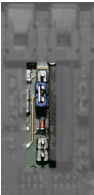
Jumperstellung für Relaisausgang. (Standard)
